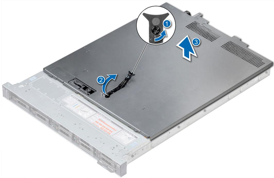
그림 24. 시스템 덮개 분리
