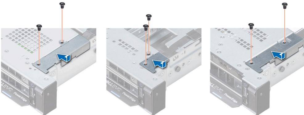
그림 96. 케이블 덮개 설치
