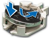
그림 80. 시스템 배터리 설치
