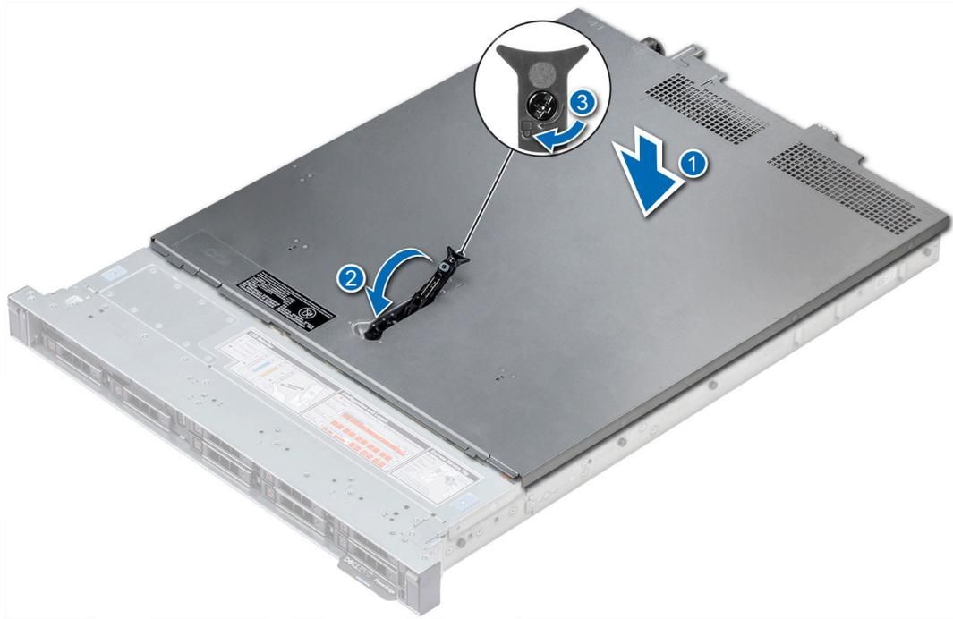
그림 25. 시스템 덮개 설치
