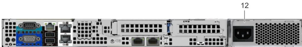
그림 13. 케이블 연결된 PSU가 있는 시스템의 후면 모습
