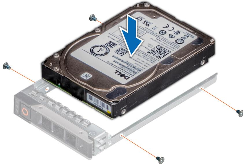
그림 40. 드라이브 캐리어에 드라이브 설치
